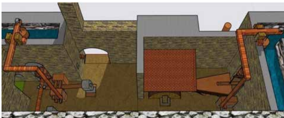
Distribución espacial de maquinaria al interior del ingenio de hierro. De izquierda a derecha: Caída de agua, noria, martinete y yunque, horno y fuelle. Elaborado por: José Orión Castellón Frech, 2021.
