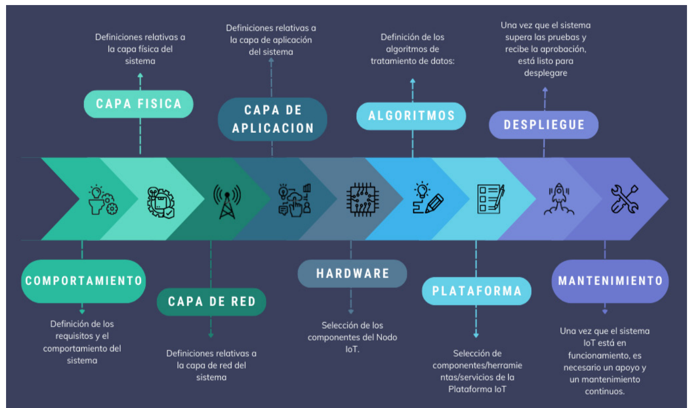
Figura 2: Secuencia de la Metodología en Capas para el diseño de sistemas IoT.
